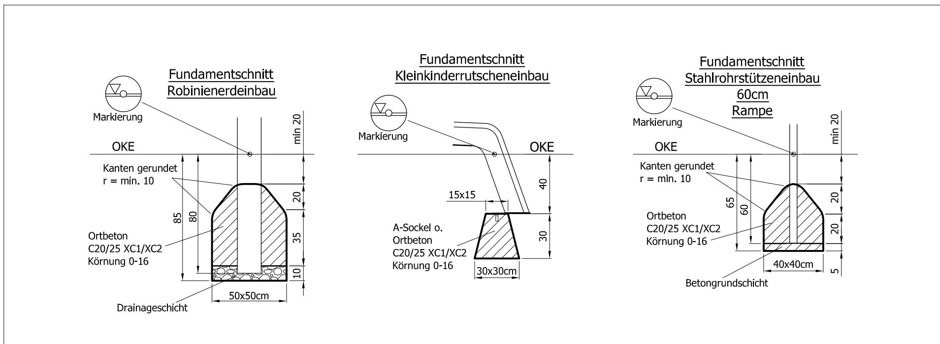
Für den Einbau unserer Geräte mit den angegebenen Fundamentgrößen, ist eine Bodenklasse 3-4 erforderlich.
